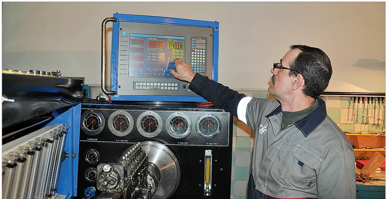
Слесарь по ремонту топливной аппаратуры Виталий Пинигин уже оценил возможности нового стенда обкатки ТНВД, приобретенного в минувшем году.
